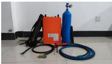
1. 收纳包; 2. 气瓶; 3. 电池组; 4. 背包带; 5. 氧气连接管; 6. 电缆线及地线夹; 7. 切割把; 8. 药芯割条; 9. 连接开关 图1 装备实物组件及连接图
